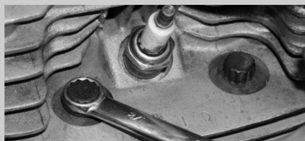
ヘッドボルトの締め順番はしっかりと憶えておこう。この部分はトルクレンチで正確に締め付けトルクを計ること。また、このボルトは12ポイントのレンチを必ず使用すること。
